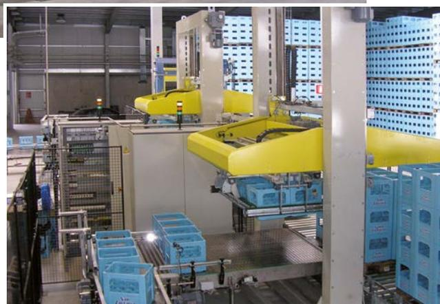
Il vantaggio che rende unica nel suo genere questa tipologia di macchina è la **totale versatilità a svolgere la funzione di palettizzatore o di depalettizzatore**. La struttura, i materiali e i componenti utilizzati garantiscono inoltre un'alta robustezza ed affidabilità della macchina nel corso del tempo, diminuendo di fatto il tempo di manutenzione periodica.
