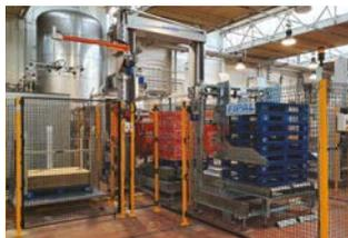
spicca quello di essere una macchina in grado di gestire una numerosa quantità di confezioni differenti, controllando ogni cambio formato in maniera semplice ed automatica da apposito pannello operatore; la serie STRATUS è disponibile **sia a singolo che a doppio ingresso**, a seconda della
